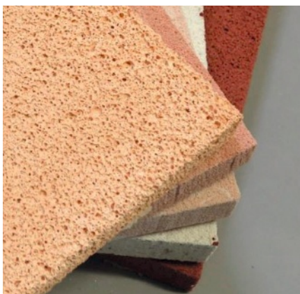
FIGURE 5 : Camaïeu de mousses IPSIIS. Différentes matières premières et différents niveaux de porosité.
