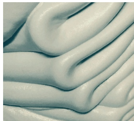
FIGURE 1 : Mousse IPSIIS à l'état plastique avant durcissement. Possibilité d'application directe sur une surface à protéger.
